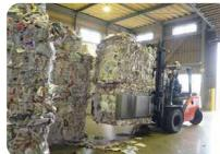
効率よく運搬・リサイクルできるよう、専用の機械で種類ごとに大きな束にまとめます。商品カタログの束は一つ約1.1トン！
