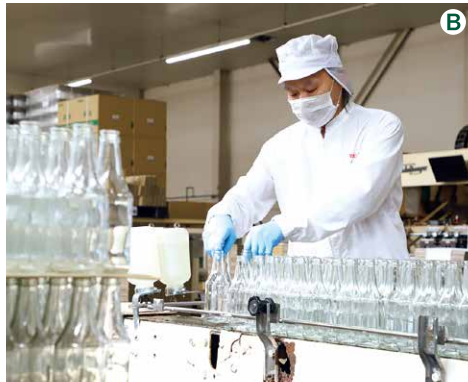
調合室。大量生産に対応するための巨大なタンクが並んでいます(写真A)。ビン詰め作業に入る前に、ビンを洗浄してから使用します(写真B)。規定の量になるように充填し、ふたをしていきます(写真C)。
