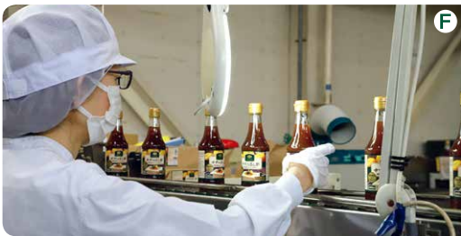
次の工程に流れていく様子(写真D)。目視検査。背後から光を当てながら、量の外観確認、またビンに傷がないかなどをチェックしていきます(写真E)。賞味期限の印字シラベルを貼ったら、賞味期限の印字が正しいか、ラベルがまっすぐ貼られているかを確認。このあと箱詰め、重量検査を経て、出荷まで倉庫で保管します(写真F)。
