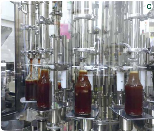
調合室。大量生産に対応するための巨大なタンクが並んでいます(写真A)。ビン詰め作業に入る前に、ビンを洗浄してから使用します(写真B)。規定の量になるように充填し、ふたをしていきます(写真C)。
