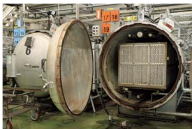
蒸し上げに使う機械。一度に最大5,500缶を蒸すことができます
